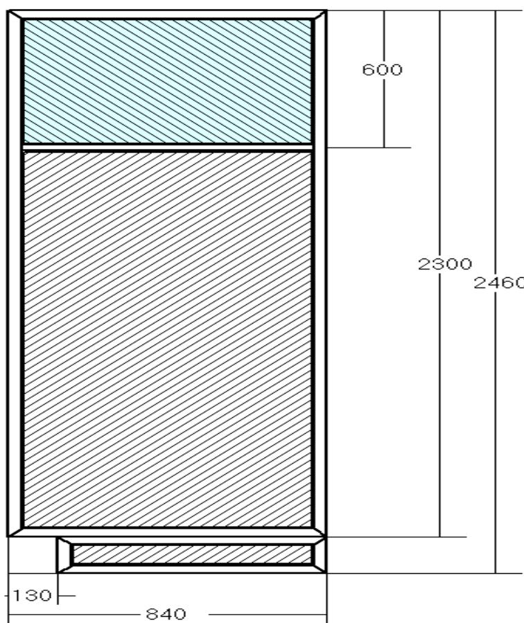
1.2. Изработка, доставка и монтаж на гише от PVC дограма, стъклопакет и первази, съгласно ориентировъчни размери посочени на чертежка – 0,59 кв.м.
